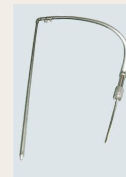
液体ヘリウムは沸点が4.2 K (-269.9°C)の超低温液体です。液体ヘリウムを容器から実験装置 (クライオスタット) へ移送するには真空断熱された特別な移送管を使用します。一般的にこの移送管をトランスファーチューブと呼びます。弊社では、様々なトランスファーチューブを製作しており、リジッドタイプ・フレキシブルタイプ・途中脱着タイプ等があります。
