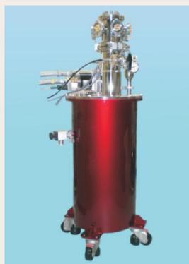
4 K冷凍機を使用したクライオスタットです。サンプルホルダーはヘリウムガス雰囲気中であり、ガス伝導にてサンプルを冷却します。サンプルホルダーのアクセス径を広く確保しておりますので、大型サンプルの冷却をすることが可能です。またトップロード機構を採用しておりますので、冷却した状態でサンプルの交換を素早く行う事が出来ます。
