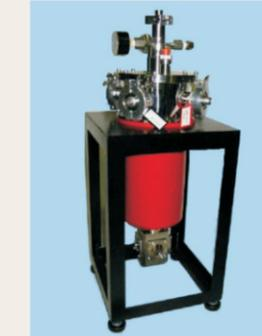
液体窒素リザーバー型クライオスタットです。フォトルミネッセンスや光半導体等の評価及び光学的測定をサポート致します。液体窒素の消費量を抑える為、トップフランジに、ニードルバルブを設けて適量の液体窒素がサンプルホルダーへ流れ込む構造になっております。サンプルホルダーに取付けたヒーターで温度コントロールを行います。
