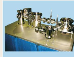
弊社では多種・多様な真空チャンバーを製作しております。真空チャンバーは使用する目的や用途により必要とする真空度が異なります。弊社では、高真空タイプ・中真空タイプ・低真空タイプの3種類を製作致しております。左記の装置は高真空タイプでコンフラットフランジを使用しており、10<sup>-5</sup> Paの真空度を得る事が可能です。(低温に冷却されたサンプルにハロゲン光を照射する装置です。)
