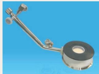
液体ヘリウムを連続フロー (吹き付け) させてサンプルを冷却するクライオスタットです。フォトルミネッセンス測定や光半導体の評価等、光学的測定をサポート致します。光導入窓の大きさはφ5 ~ φ50 mmまで対応可能です。窓材質は石英ガラスが標準ですが、他の材質にも対応出来ます。
