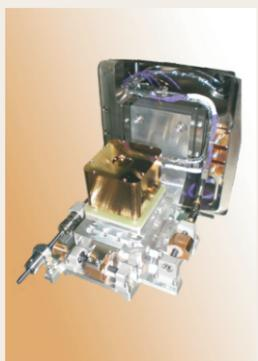
本装置はCL (カソードルミネッセンス) 用に開発された装置です。液体ヘリウム連続フロー型クライオスタットの技術を採用しています。電子顕微鏡は振動を嫌う為、ヘリウムの供給及び戻りのラインに細いステンレス管を使用しており、外部からの振動を除去しております。さらに冷却によるサンプルホルダーの膨張・収縮を最低限に抑える為、熱交換器全体にヒーターを取付け、温度コントロール時の膨張・収縮を抑えた構造にしております。高倍率下でもサンプルが視野から外れない様、設計されています。専用の液体ヘリウムトランスファーチューブは一般の2重管方式ではなく、弊社オリジナルの3重管方式を採用しておりますので、ヘリウムの消費量を抑える事が可能です。
