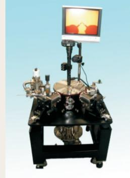
半導体デバイスの温度依存性を評価する装置です。冷却方式として下記の方法があります。
