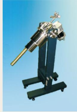
20 KGM冷凍機を使用した電磁石挿入型クライオスタットです。磁気抵抗測定、ホール効果測定、超電導体の臨界温度・臨界磁場測定等、磁場中での幅広い物性測定が可能です。クライオスタットは0 ~ 90°まで回転可能で、特別な架台を使用することなく、電磁石に設置する事が出来ます。さらにテール部に光学窓を取付ける事も可能で、カー効果測定等にも対応致します。
