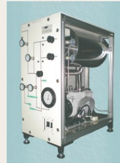
多種・多様なガスハンドリングシステムを製作しています。左記の装置は3Heガスハンドリングシステムです。3Heガスは4Heガスの同位体です。液体の4Heを減圧して1 ~ 1.5 Kの低温を作り、3Heガスを熱接触させてと液化します。液化した3Heを断熱状態で減圧すると0.3 K程度まで冷却する事が出来ます。しかし3Heガスは非常に高価であるため、取扱いを注意しなければなりません。また密閉状態で循環を行い、何度でも再利用が出来るように設計しなければなりません。弊社ではお客様の仕様に合わせて設計・製作致しております。ガス配管はリークディテクターでリークがない事を確認して出荷しております。
